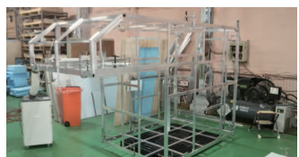
軽くて頑丈なアルミ合金の構造体! しかも溶接で一体化!
