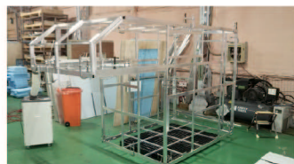
軽くて頑丈なアルミ合金の構造体! しかも溶接で一体化!
